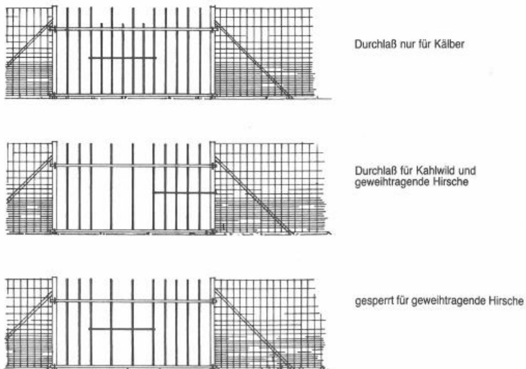
**Abb. 1.19.** Funktionsschema eines Absperrgatters im Wildgehege
